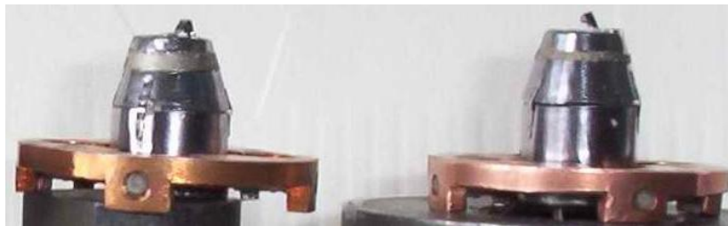
Рис. 6. Фотографии экспериментальных катодов для МИП с разной шириной эмитирующего пояса
