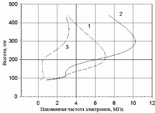
Рис. 1. Вертикальные профили плазменной частоты электронов по модели Ching – Chiu, где кривая 1 – зима, день, \bar{W}=16 ; кривая 2 – зима, день, \bar{W}=100 ; кривая 3 – зима, ночь, \bar{W}=100 .
